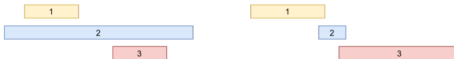
Слика 9.7: Пример на коме стратегија која распоређује час који први почиње и пример на коме стратегија која распоређује час који је најкраћи даје неоптимално решење
